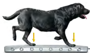
Biomekanisk kraftplate med integrert vekt. Hastighet mellom 1,7 og 2,1 m/s
